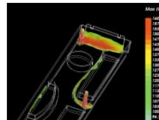
離型時における温度分布表示 温度120℃以上の部位を島表示
